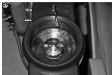
図19 薬液による給水ラインの消毒 fig. 19 Disinfection of the water supply line with a chemical solution
