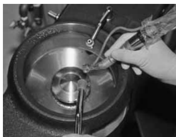
図1 切削器具使用後の空運転
