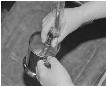
図3 発泡を抑制するため攪拌しながら洗浄 fig. 3 Wash while stirring to suppress foaming
